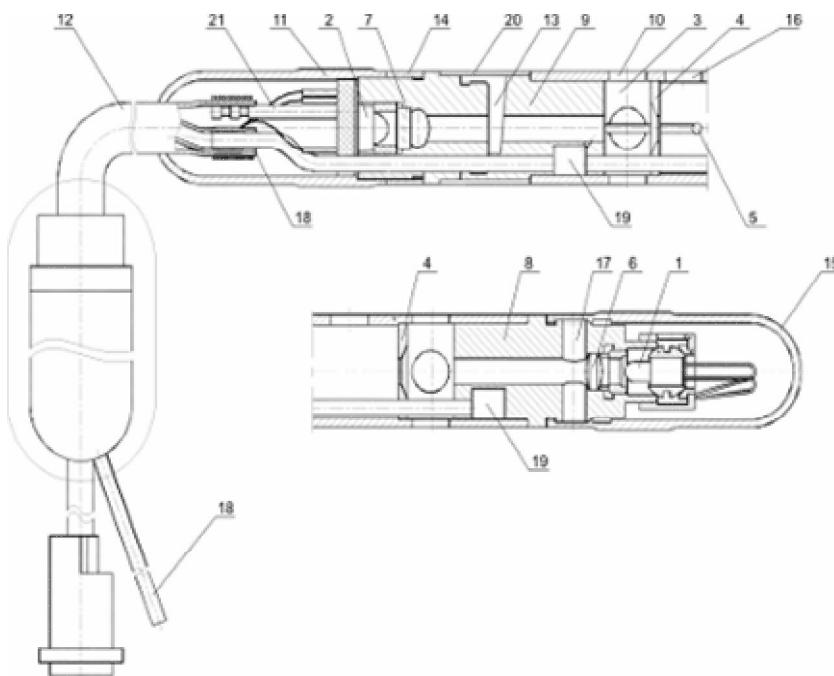
1-Лампа накаливания; 2-Фотоприемник; 3-Измерительная камера; 4-Диафрагма; 5-Термодатчик; 6-Оптическая линза;
