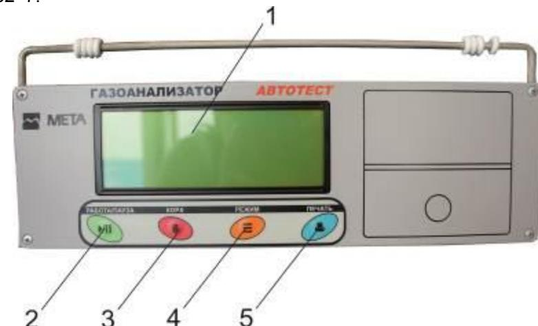
1-Индикатор; 2-Кнопка РАБОТА/ПАУЗА; 3-Кнопка КОРР.0; 4-Кнопка РЕЖИМ; 5-Кнопка ПЕЧАТЬ.
