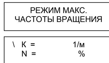
Затем прибор начнет непрерывно измерять и каждую секунду отображать показатели дымности.
