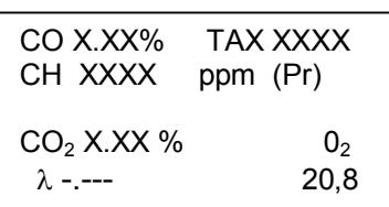
Примечание – Основную информацию о качестве сжигания топлива несут O<sub>2</sub> и λ - параметр.
