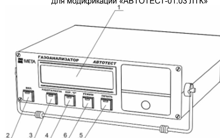
1-Индикатор; 2-Кнопка включения питания ВКЛ; 3-Кнопка РАБОТА/ПАУЗА; 4-Кнопка КОРР.0; 5-Кнопка ПЕЧАТЬ; 6-Кнопка РЕЖИМ
