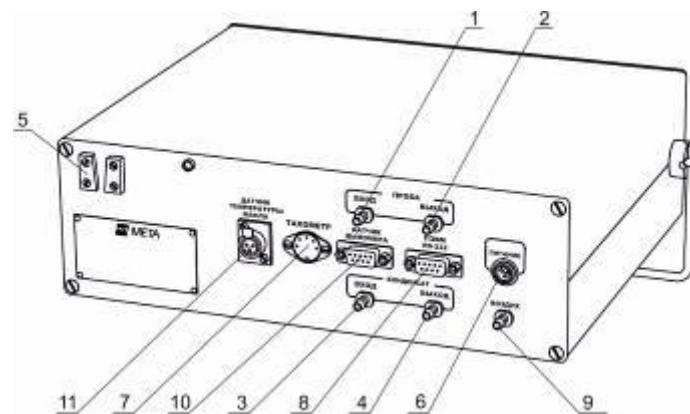
1-Штуцер для подачи газа ВХОД; 2-Штуцер вывода газа ВЫВОД; 3-Штуцер подачи конденсата ВХОД; 4-Штуцер вывода конденсата ВЫХОД; 5-Крепление фильтра тонкой очистки; 6-Разъем питания; 7-Разъем тахометра; 8-Разъем для подключения компьютера; 9-Штуцер подачи чистого воздуха; 10-Разъем для подключения датчика дымомера; 11 – Разъем для подключения датчика температуры масла (опция)
