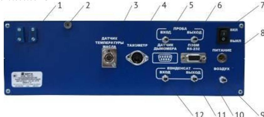
1-Крепление фильтра тонкой очистки (каплеуловителя), 3 - Разъем для подключения датчика температуры; 4 - Разъем тахометра; 5 - Штуцер подачи газа ВХОД; 6 - Штуцер вывода газа ВЫХОД; 7 – Кнопка ВКЛ/ВЫКЛ; 8 - Разъем питания; 9 - Штуцер подачи чистого воздуха; 10 - Разъем для подключения компьютера; 11 - Штуцер вывода конденсата ВЫХОД; 12 - Штуцер подачи конденсата ВХОД.
