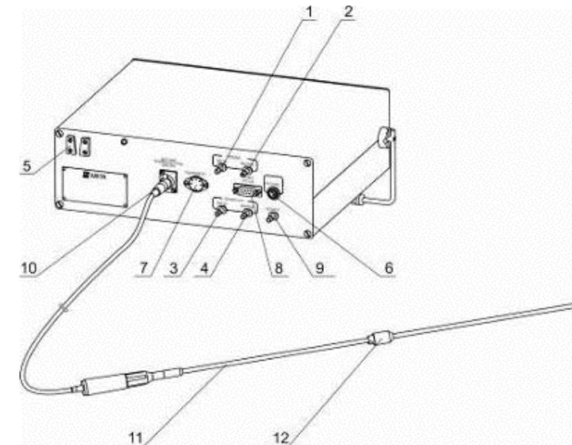
1-Штуцер подачи газа ВХОД; 2- Штуцер вывода газа ВЫХОД; 3- Штуцер подачи конденсата ВХОД; 4- Штуцер вывода конденсата ВЫХОД; 5-Крепление фильтра тонкой очистки (каплеуловителя); 6-Разъем питания; 7-Разъем тахометра; 8-Разъем для подключения компьютера; 9-Штуцер подачи чистого воздуха; 10-Разъем для подключения датчика температуры; 11-Датчик температуры; 12-Ограничитель
